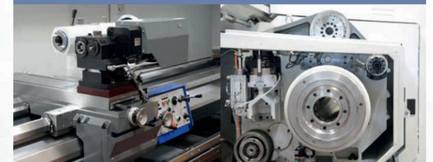
Werkzeugträgerkopf zum Drehen, Bohren und Fräsen
