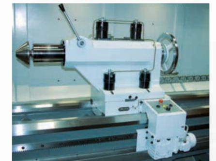
Reitstock mit automatischer Klemmung und eigenem Antrieb
