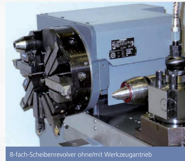
8-fach-Scheibenrevolver ohne/mit Werkzeugantrieb
