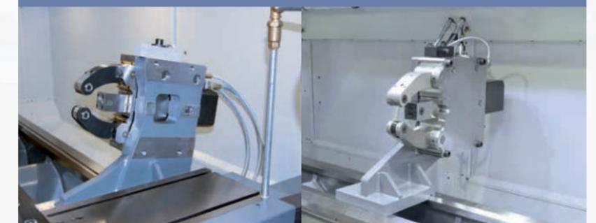
Mitlaufende, selbstzentrierende Lünette, hydraulisch betätigt
